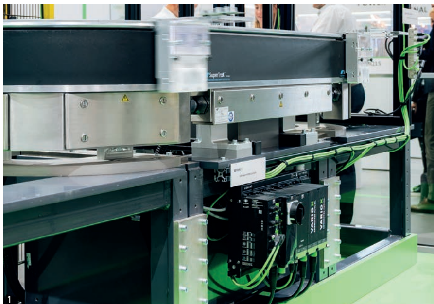
Das Vario-X System von Murrelektronik ermöglicht eine modulare Maschinenarchitektur mit dezentraler Intelligenz
