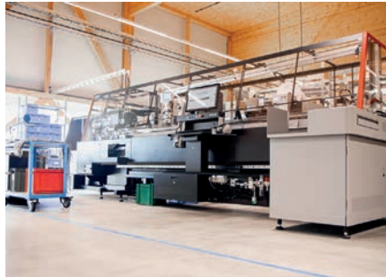
Die voll automatisierte Drahtkonfektionieranlage verarbeitet bis zu 36 unterschiedliche Drähte mit Querschnitten von 0,5 mm 2 bis 10 mm 2 in verschiedenen Farben.
