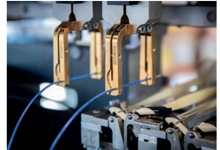
Die voll automatisierte Drahtkonfektionieranlage verarbeitet bis zu 36 unterschiedliche Drähte mit Querschnitten von 0,5 mm 2 bis 10 mm 2 in verschiedenen Farben.
