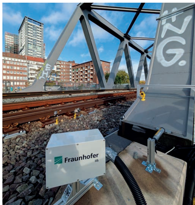
Die verhältnismäßig kostengünstige Radarsensorik für autonome Fahrzeuge kann mit entsprechenden Anpassungen auch für infrastrukturelles Monitoring genutzt werden
