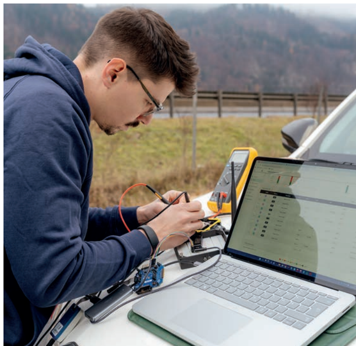
Finaler Funktionstest eines intelligenten autonomen Sensorsystems vor Montage an einer Steinschlag-Schutzverbauung
