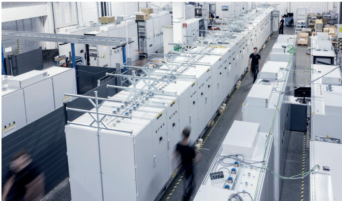
Gewaltiges Batterie-Prüffeld: Aneinandergereiht ergeben sich 165 Meter an Schaltschränken und 650 Meter Kabellänge mit 5 Tonnen Gewicht.
