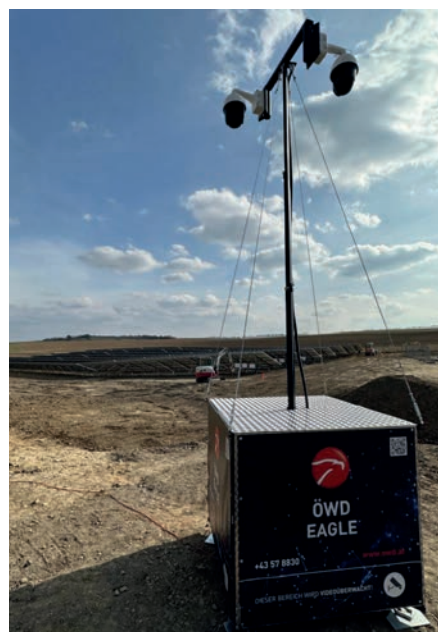
Der ÖWD Eagle sichert Baustellen und unbewachte Flächen, erkennt Gefahren in Echtzeit und meldet Alarme direkt an das NSC.
