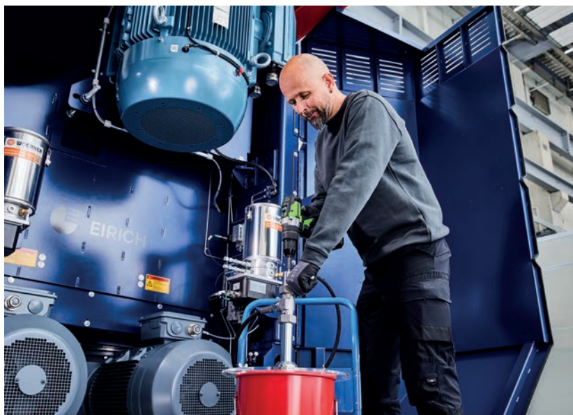
Mit der Kraft des Akkuschaubers können bis zu zwei Kilo Schmierfett pro Minute gefördert werden.
