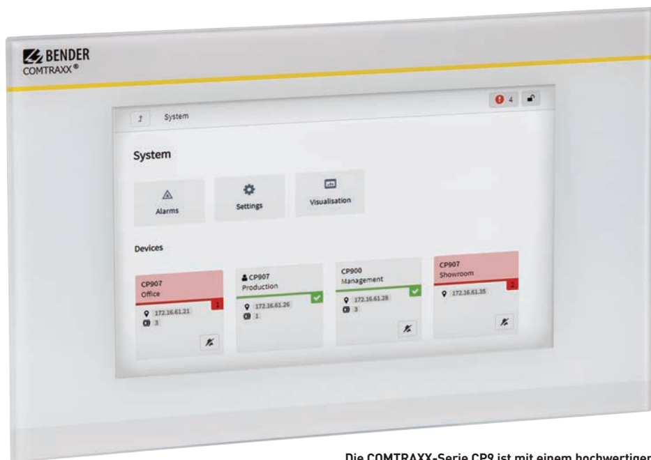
Die COMTRAXX-Serie CP9 ist mit einem hochwertigen berührungssensitiven TFT-Touchdisplay ausgestattet, das aufgrund der gehärteten Glasoberfläche dem robusten Industriestandard entspricht.
