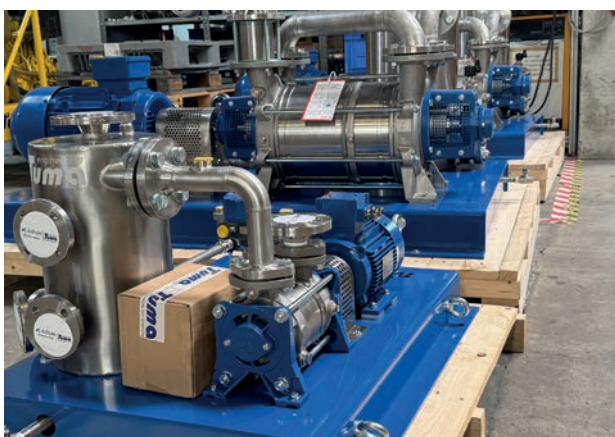
Die Flüssigkeitsring-Vakuumpumpen von TUMA fördern und verdichten Gase in diversen Anwendungen und werden in besonderen Ausführungen auch zum Fördern von explosiven Gasen, z.B. von Wasserstoff und Dämpfen, eingesetzt.
