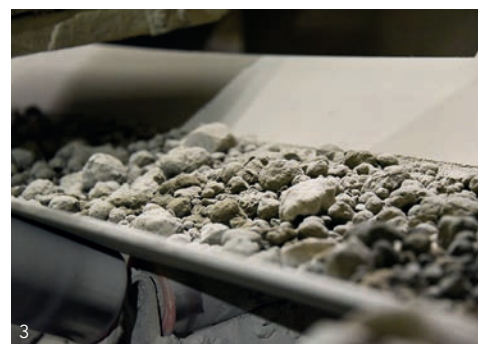
Der Klinkeranteil ist bei CEM-II/C-Zementen auf eine Bandbreite von nur 50–65 Prozent reduziert.
