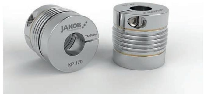
dank der Klemmnabenkonstruktion. Zudem bietet die Kupplung ein geringes Trägheitsmoment sowie gute Werte für zulässige Wellenversätze und Rückstellkräfte. Der mehrlagige Metallbalg aus zertifiziertem Edelstahl bietet eine hohe Verdrehsteifigkeit und gleicht axiale, radiale und laterale Wellenversätze aus. Durch die verkürzte Bauweise wird Gewicht eingespart, was zu einem niedrigeren Massenträgheitsmoment führt.
