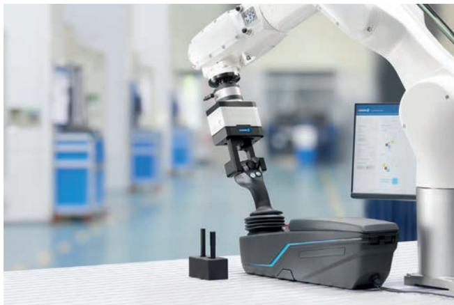
*Der Kraft-Momenten-Sensor FTS erfasst Prozesskräfte und -momente mit hoher Auflösung und Genauigkeit und führt so zu präzisen Ergebnissen und gleichbleibender Qualität in der automatisierten Fertigung.*
