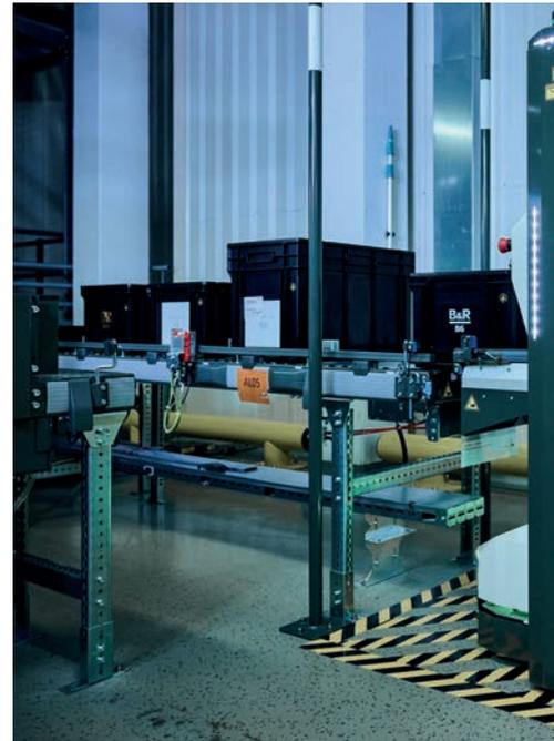
Das Herzstück der neuen Smart Factory von B&R ist das automatische Kleinteilelager Evo Shuttle. Es erhöhte den Lagerdurchsatz um 35 Prozent (1).
