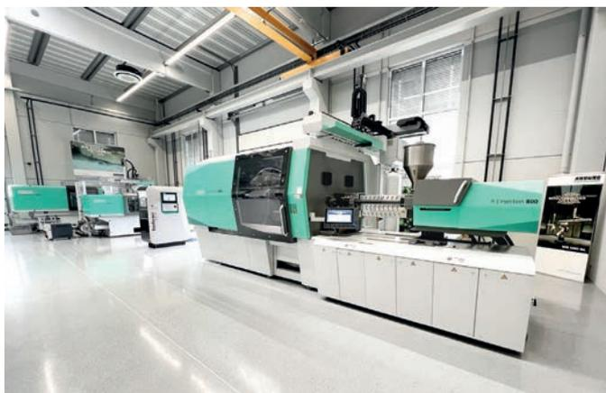
Mehrere Allrounder mit Multilift-Robot-Systemen von Arburg stehen Kunden im Technikum Inzersdorf zu Test-, Schulungs- und Abmusterungszwecken zur Verfügung.
