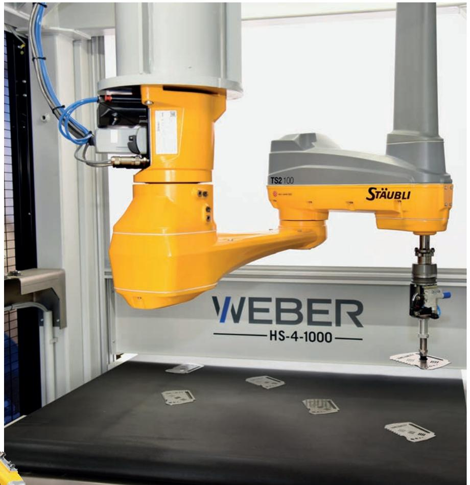
In einer Entladezelle der Hans Weber Maschinenfabrik übernimmt ein Stäubli-SCARA-Roboter dank KI das Ab stapeln beliebiger Teile ohne vorheriges Einlernen.
