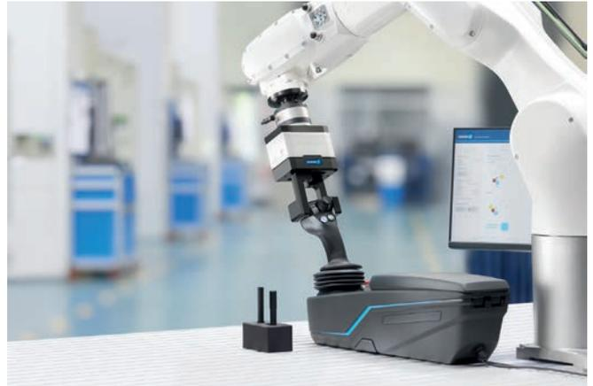
*Der Kraft-Momenten-Sensor FTS erfasst Prozesskräfte und -momente mit hoher Auflösung und Genauigkeit und führt so zu präzisen Ergebnissen und gleichbleibender Qualität in der automatisierten Fertigung.*
