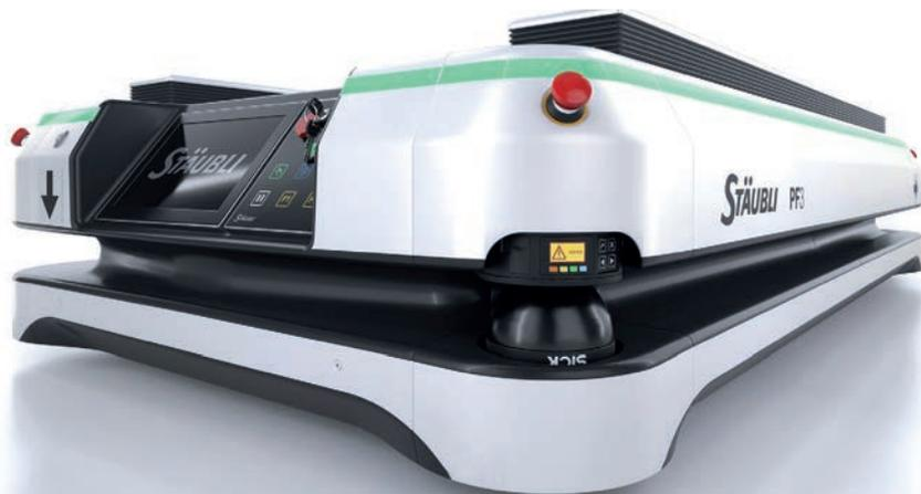
Neu im Programm: Mobilroboterlösungen – darunter die mobile Transportplattform PF3, die durch ihre ultrakompakte Bauweise das Transportieren und Heben von bis zu 3 Tonnen mit hoher Positioniergenauigkeit ermöglicht.
