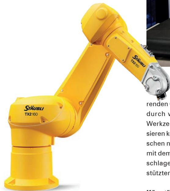
Der TX2-160 von Stäubli übernimmt mit hervorragender Präzision und Wiederholgenauigkeit Arbeiten am Werkstück.
