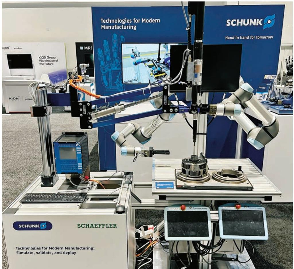
Automatisierung am Beispiel einer Schraubmontageanwendung – digital und physisch Hand in Hand
