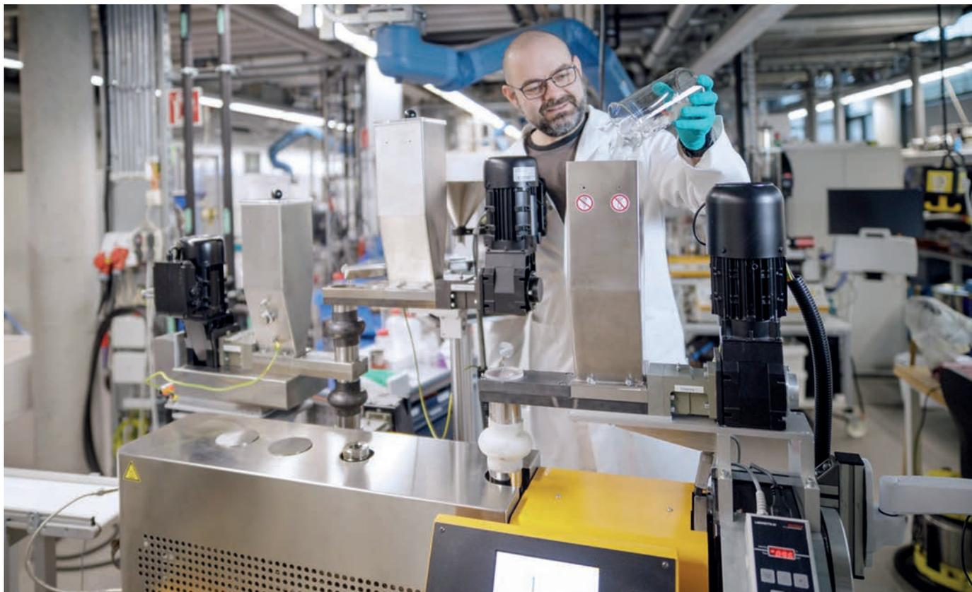
Am Fraunhofer IFAM werden die gereinigten Kunststoffabfälle im Compounder gemischt, aufgeschmolzen und extrudiert.
