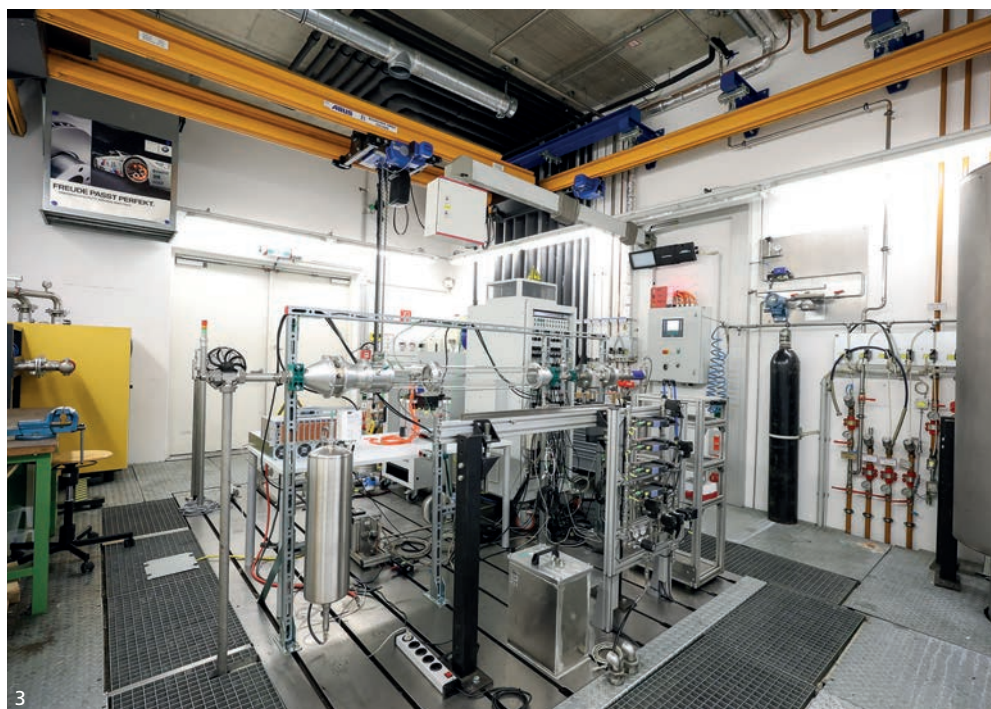
Eröffnung des neuen Wasserstoff-Elektrolyse-Testzentrums am Campus Inffeldgasse der TU Graz (1). Das neue Wasserstoff-Elektrolyse-Testfeld mit eigener Trafostation. Auf der Fläche werden containerisierte Elektrolyseure mit einer Gesamtleistung von bis zu 2,5 MW aufgestellt (2). Stack-Prüfstand für Brennstoffzellen und Elektrolyseure am Institut für Thermodynamik und nachhaltige Antriebssysteme der TU Graz. (3)
