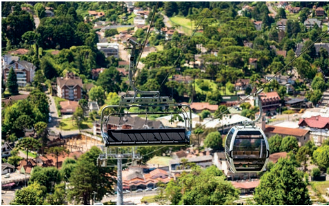
Die Teleférico Parque Capivari (Brasilien) ist die erste Kombibahn in Lateinamerika und bietet den Fahrgästen die Wahl zwischen 6er-Sesseln und 8er-Kabinen (links). Die TRI-Line verbindet die Vorteile des leistungsstarken 3S-Systems mit denen der bewährten DLine (rechts).
