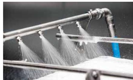
Automatisierte Reinigung eines Förderbandes
