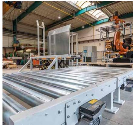
Vollautomatische Palettieranlage für Dämmstoffplatten
