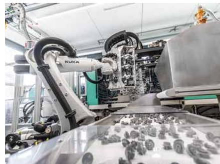
Ein KR QUANTEC entnimmt bei der Hermann Hauff GmbH & Co. KG simultan zum Spritzzyklus die Rollen aus dem unteren Teil des Würfels, setzt sie in die Steckbuchsen ein, um die fertigen Teile aus Kunststoff danach zu entnehmen.
