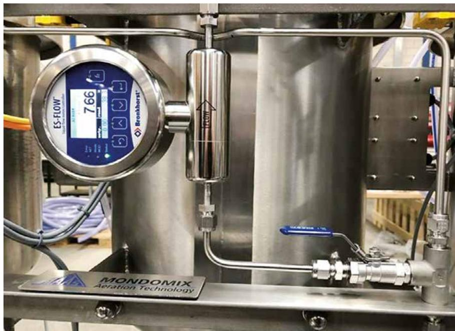
ES-FLOW-Ultraschall-Volumendurchflussmesser zur Messung der Zufuhr von Zusatzstoffen bei der Herstellung von Süßigkeiten
