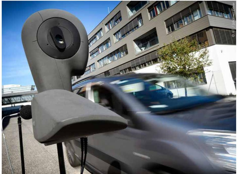
Mithilfe einer Akustik Mess-Anlage wird Lärm und Geräusentwicklung getestet.
