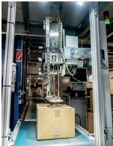
Ab hier läuft alles vollautomatisch: Das Paket wird verschlossen, gewogen und vermessen. Anhand der Faktoren Gewicht, Maße und Destination ermittelt die Software den günstigsten Paketdienst für jede einzelne Sendung. Diese Daten werden an den Etikettendruckspender Legi-Air 4050 der Bluhm Systeme GmbH aus Rheinbreitbach übertragen.
