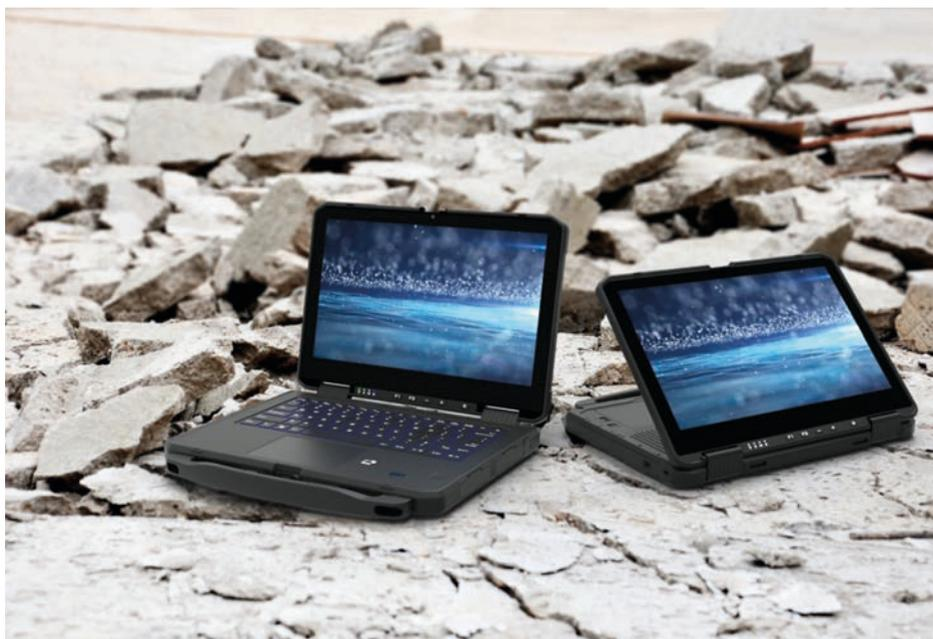
Durch einfaches Schwenken des Displays um 360 Grad wird aus dem Heavy Duty Laptop ein Rugged Industrial Tablet PC. Dabei wechselt der Eingabemodus von Tastatur/Trackpad auf Touchscreen.
