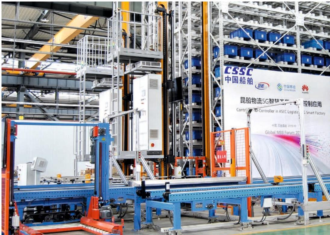
Das intelligente Lager von KSEC Intelligent dient neben dem Lagerbetrieb auch als Testfeld für moderne Logistik, bei der Steuerungssysteme u. a. in Verbindung mit 5G-Kommunikation getestet werden.
