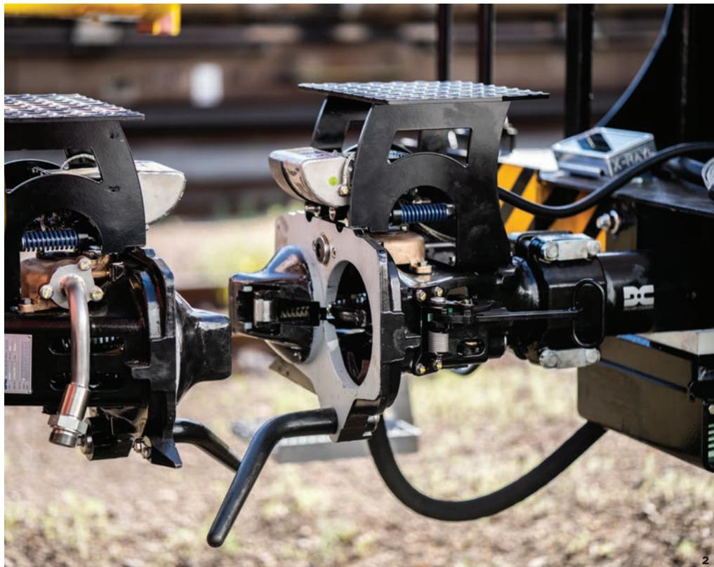
Die Digitale Automatische Kupplung soll von 2026 bis 2030 die herkömmliche Schraubenkupplung in Europa schrittweise ablösen.
