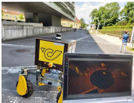
Der Prototyp eines „Last Mile Delivery Robot“ mit umfangreicher Sensorausstattung
