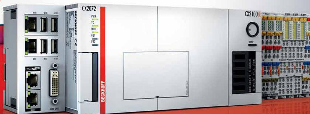
Die Embedded-PCs der Serie CX2000 definieren die Maßstäbe für Hutschienen-PCs neu. Mit 4, 8 oder sogar 12 Kernen, Task-Zykluszeiten pro Kern von 100  $\mu$ s und hoher Temperaturstabilität von -25 °C bis +50 °C bietet dieser Embedded-PC einen echten Leistungsschub im hochkomprimierten Format. Das Ergebnis: minimaler Footprint und höchste Steuerungsleistung auf der Hutschiene – ideal für leistungsintensive Automation- und Motion-Anwendungen.
