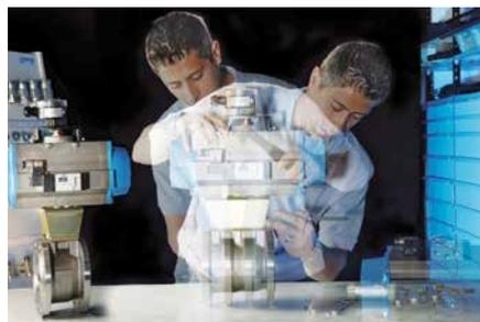
Montage eines Kugelhahns mit pneumatischem Drehantrieb
