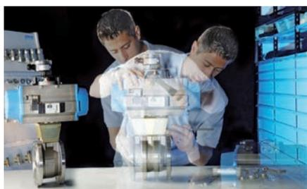
*Montage eines Kugelbahns mit pneumatischem Drehantrieb.*
