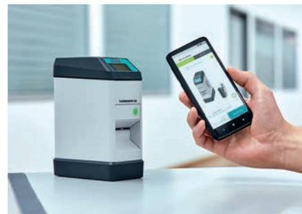
*Drabtllose Schnittstelle: Über NFC oder Bluetooth kommuniziert die App Marking system mit dem mobilen Drucker.*
