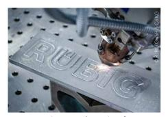
Der Prozess des Laserauftragsschweißens
