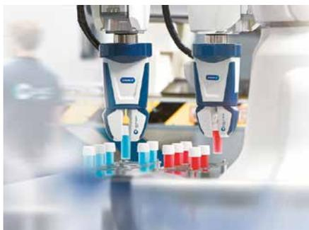
Mechatronische Greifsysteme erreichen dank bürstenloser DC-Motoren mit nur 22 mm Durchmesser und integriertem Motion-Controller ohne weiteres die Leistung ihrer pneumatischen Pendants.
