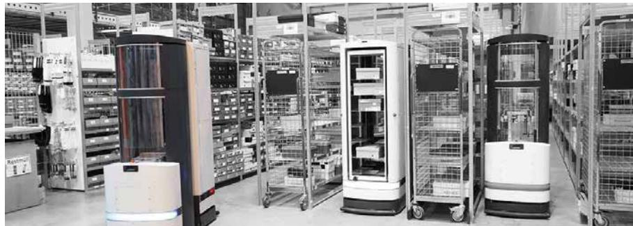
Der Logistik-Roboter TORU kombiniert autonomes Fahren mit Handlings-Robotik. Per Unterdruck werden die Waren aus dem Regal genommen. Eine Metallzunge schließt vor dem Ansaugen die Lücke zwischen Regalboden und Logistikroboter. Sowohl das Ausfahren der Zunge als auch das Bewegen des Greifarms übernehmen bürstenlose DC-Servomotoren von FAULHABER.
