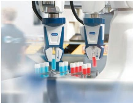
Mechatronische Greifsysteme erreichen dank bürstenloser DC-Motoren mit nur 22 mm Durchmesser und integriertem Motion-Controller ohne weiteres die Leistung ihrer pneumatischen Pendants.
