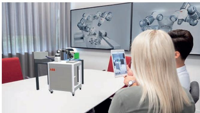
Die zugrundeliegende AR-Technologie bietet die Möglichkeit, das in RobotStudio® simulierte Modell in die reale Produktionsumgebung einzubetten, entsprechend zu skalieren und aus verschiedenen Blickwinkeln zu betrachten.
