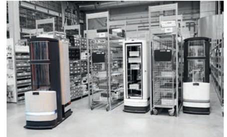
Der Logistik-Roboter TORU kombiniert autonomes Fahren mit Handlings-Robotik. Per Unterdruck werden die Waren aus dem Regal genommen. Eine Metallzunge schließt vor dem Ansaugen die Lücke zwischen Regalboden und Logistikroboter. Sowohl das Ausfahren der Zunge als auch das Bewegen des Greifarms übernehmen bürstenlose DC-Servomotoren von FAULHABER.
