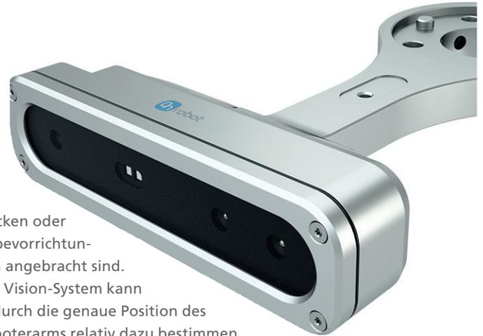
stücken oder Hebevorrichtungen angebracht sind. Das Vision-System kann dadurch die genaue Position des Roboterarms relativ dazu bestimmen. Dies reduziert den Programmieraufwand und ermöglicht dem Roboter ein präziseres Greifen.
