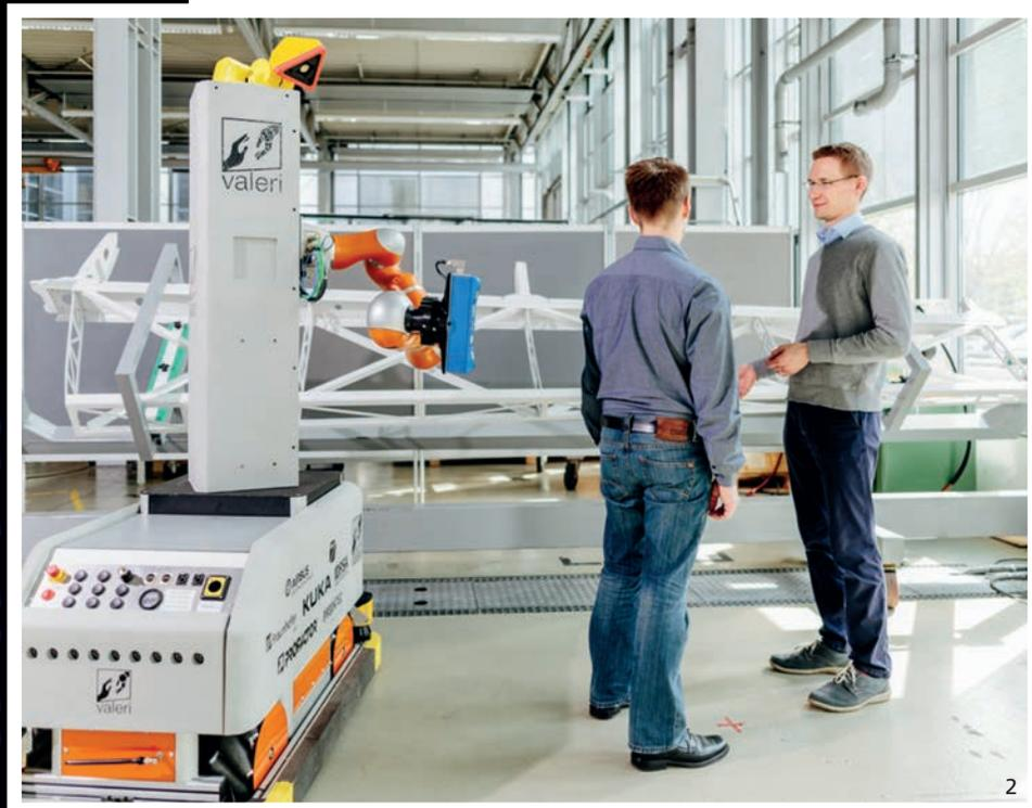
Mit Computer-Aided-Safety des Fraunhofer IFF können bereits in der Planungsphase Robotergeschwindigkeiten und der Platzbedarf simuliert werden.
