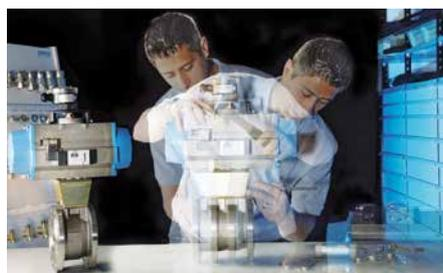
Montage eines Kugelhahns mit pneumatischem Drehantrieb
