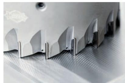
Um Auswaschungen am Grundkörper zu verhindern und einen wirtschaftlichen Produktlebenszyklus zu erhalten, wurde das Kühlkonzept optimiert und die Kühlmittelaustritte direkt an die Schneiden positioniert. Das sorgt für eine verbesserte Spanabfuhr und schont den Grundkörper, insbesondere bei Anwendungen mit Minimalmengenschmierung oder Luftkühlung.
