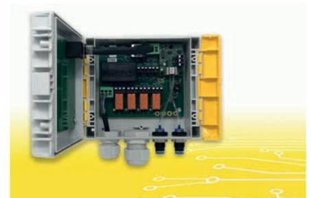
neuen Version 4.0 vorliegt, kann der Regler nicht nur wie bisher direkt am Gerät, sondern auch ganz unkompliziert über PC oder Notebook parametrierbar werden. Zu diesem Zweck lässt sich die integrierte Service-Schnittstelle des HE 5422 (USB/B) mit einem USB-/TTL-Adapter aufrüsten. Der Arbeitsbereich des Reglers ist über zwei Alarm-Grenzwert-Kontakte definiert (untere/obere Schwelle).
