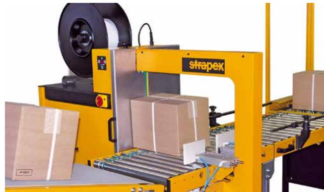
Vollautomatische Umreifungsmaschine, integriert im Produktionsprozess
