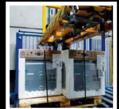
Anlage mit automatischer Kantenschutzauflage
