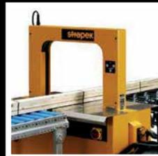
Hochleistungsmaschinen zum voll- bzw. halbautomatischen Umreifen
