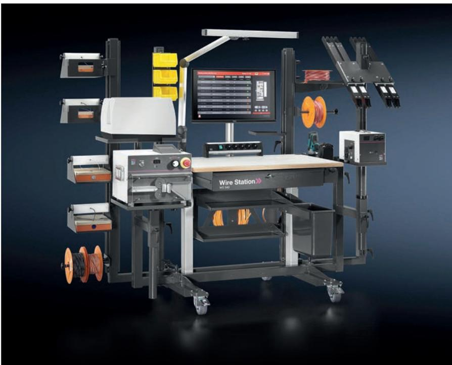
Dank Baukastensystem lässt sich der Verdrahtungstisch individuell an den Konfektionierungsprozess anpassen: In Verbindung mit dem Drahtkonfektionier-Vollautomaten Wire Terminal und dem Softwaretool EPLAN Smart Wiring gelingt ein weiterer Schritt in Richtung Automatisierung.
