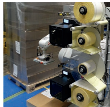
Eines der neuesten Projekte bei Bluhm Österreich ist der „Pallet-Labeling-Robot“, eine höchst flexible Roboterlösung zur Palettenetikettierung.
