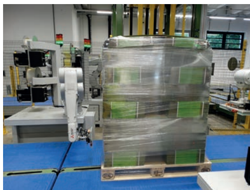
Eines der neuesten Projekte bei Bluhm Österreich ist der „Pallet-Labeling-Robot“, eine höchst flexible Roboterlösung zur Palettenetikettierung.
