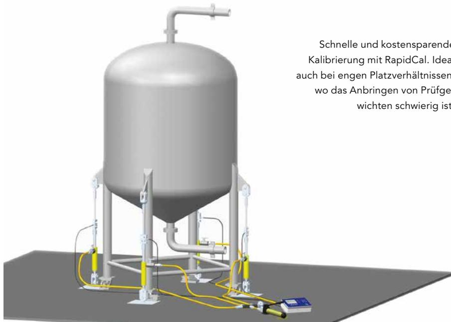
**Z**eitaufwendige, zugleich teure Kalibriermethoden mit unzureichender Präzision und Rückführbarkeit gehören der Vergangenheit an. Die neue RapidCal™-Tankwaagen-Kalibrierung ermöglicht eine kostengünstige und schnelle Kalibrierung – ohne Testgewichte und Flüssigkeiten.
