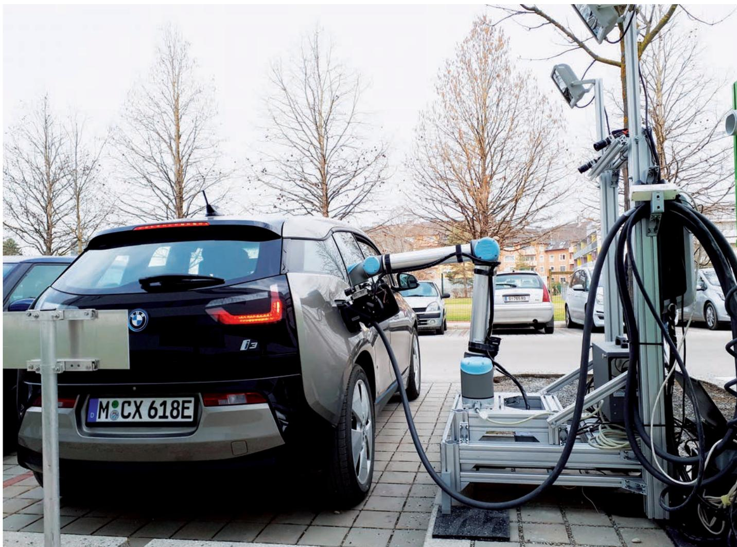
Das robotergesteuerte CCS-Schnellladesystem für E-Fahrzeuge ermöglicht erstmals auch das serielle Laden von Fahrzeugen in unterschiedlichen Parkpositionen. Das Ladesystem ist für Standard- und Normladestecker von E-Fahrzeugen konzipiert.
