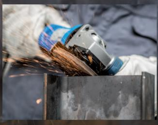
wie eine herkömmliche Schruppscheibe eingesetzt werden und bietet aufgrund ihres besonderen Aufbaus ergonomische Vorteile durch deutlich geringere Lärmemission und weniger Vibration als bei konventionellen Schruppscheiben."
