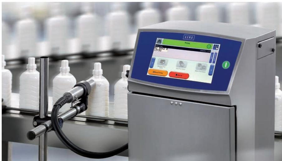
Bei der neuesten Generation der Linx-Drucker besteht die Möglichkeit der Fernwartung.
