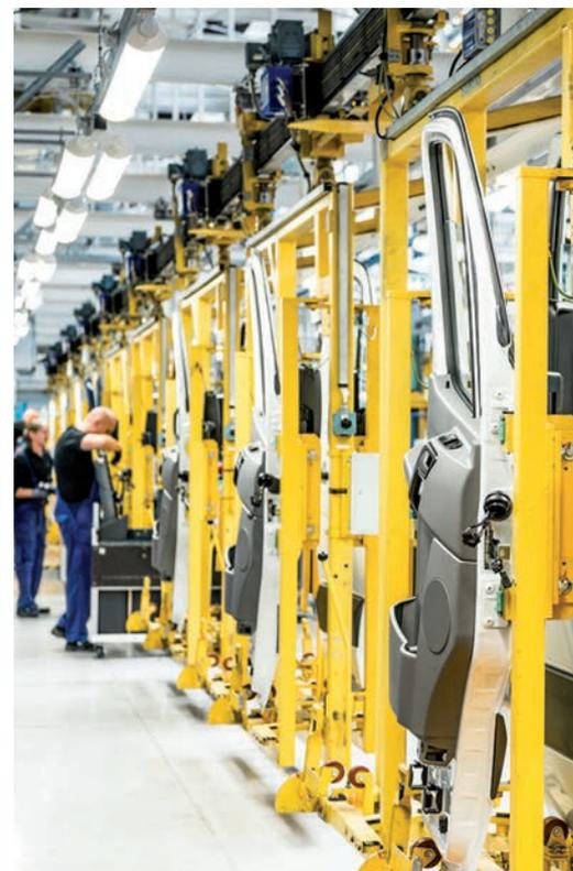
Oben: Viele Bauteile sind für die Werker kaum zu unterscheiden. Links: Zunächst werden Seitenspiegel und Sitze mit RFID-Tags ausgestattet.
