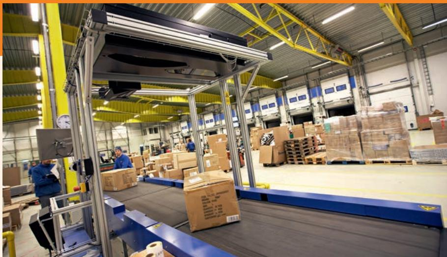
Die Komplettlösung TLX MultiCapture™ ermöglicht die dynamische Datenerfassung von Gewicht, Volumen und genauer Identifikation (Barcode).
