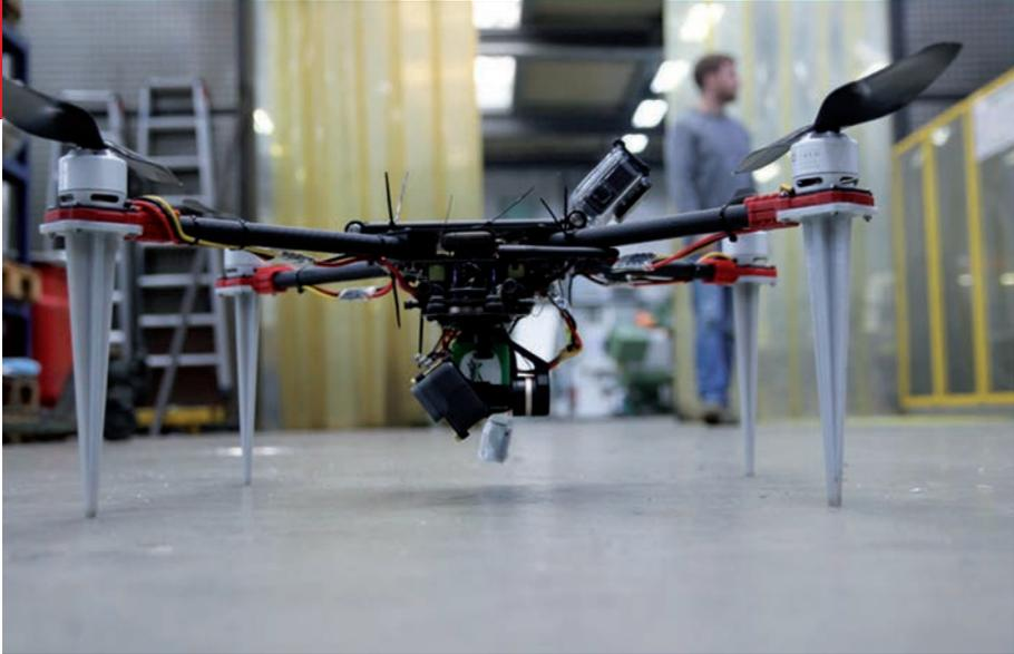
Kommt bei der Analyse des Ist-Zustands einer Fabrik eine Drohne zum Einsatz, lässt sich die Planung neuer Anlagen und Wege deutlich beschleunigen.
