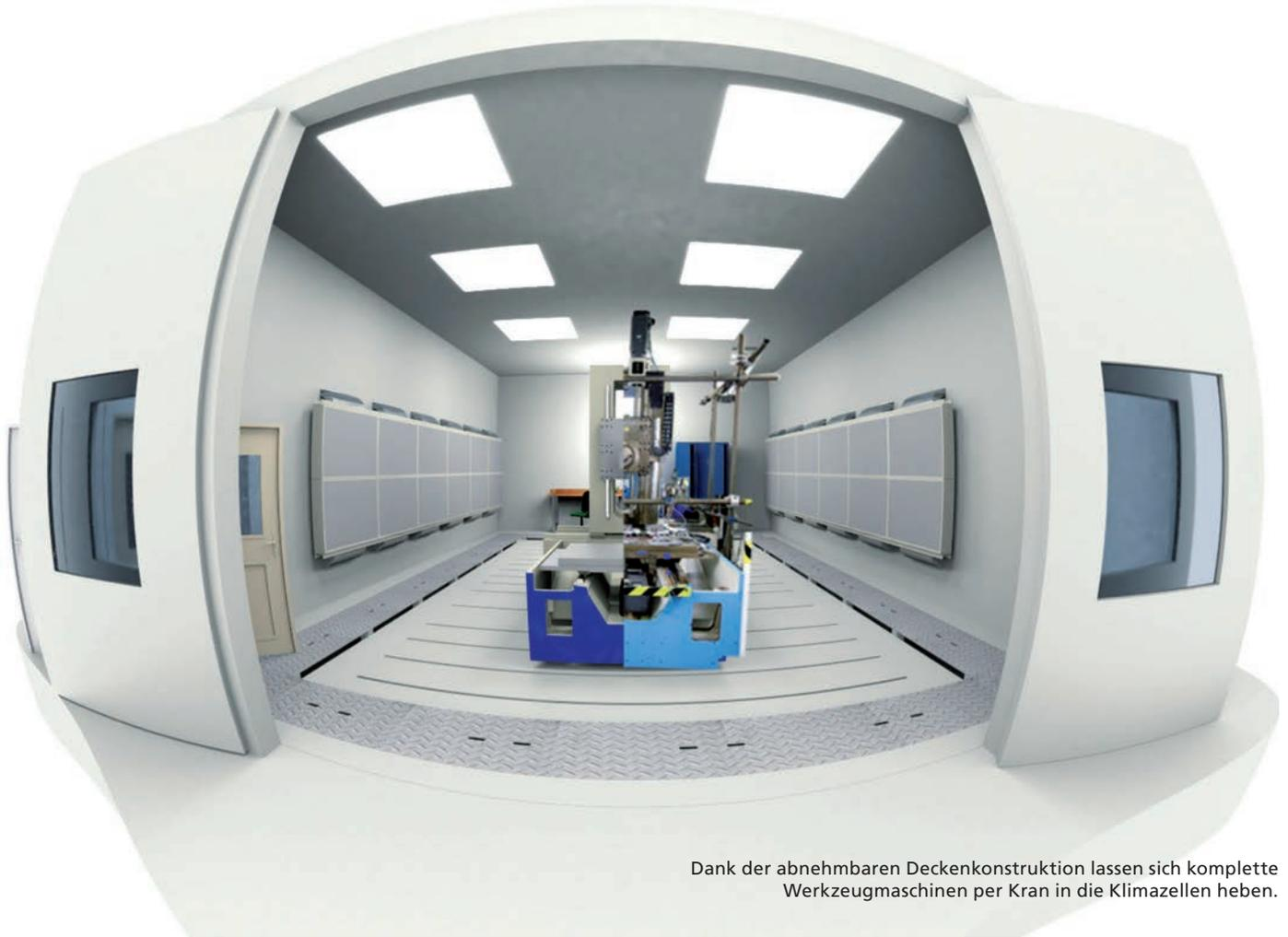
Dank der abnehmbaren Deckenkonstruktion lassen sich komplette Werkzeugmaschinen per Kran in die Klimazellen heben.
