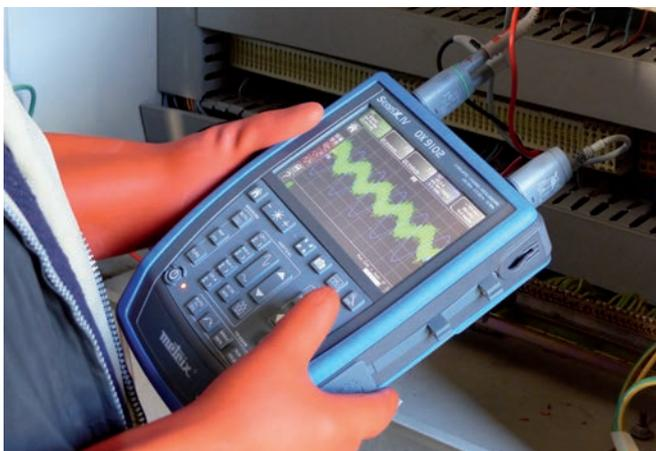
Oberschwingungsanalysator, Datenlogger und Aufruf von auf dem Oszilloskop abgespeicherten Dateien. Die durchdachte intuitive Bedienbarkeit inklusive dem Plug-and-play-Zubehör PROBIX zur schnellen und fehlerfreien Inbetriebnahme bietet einen optimalen Nutzerkomfort.
