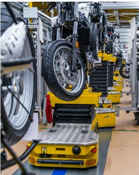
Fahrerlose Transportsysteme von DS AUTOMOTION ermöglichen eine agile Montage nach den Grundsätzen von Industrie 4.0.
