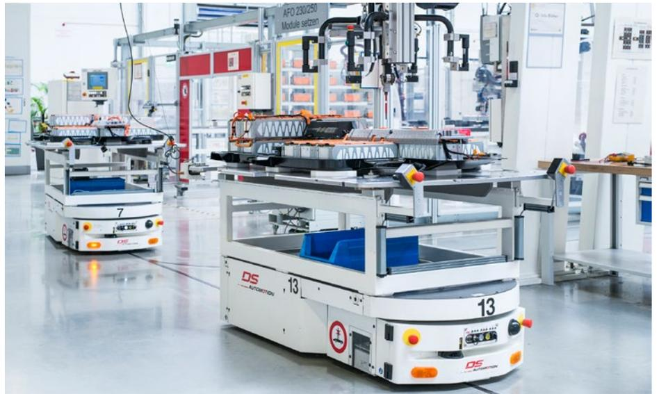
In der Batteriemontage nutzen die meisten deutschen Premium-Hersteller (im Bild Volkswagen in Braunschweig) Fahrerlose Transportsysteme von DS AUTOMOTION, weil sich die Produktion flexibel gestalten lässt, vor allem in Hinblick auf die steigenden Produktionszahlen.
