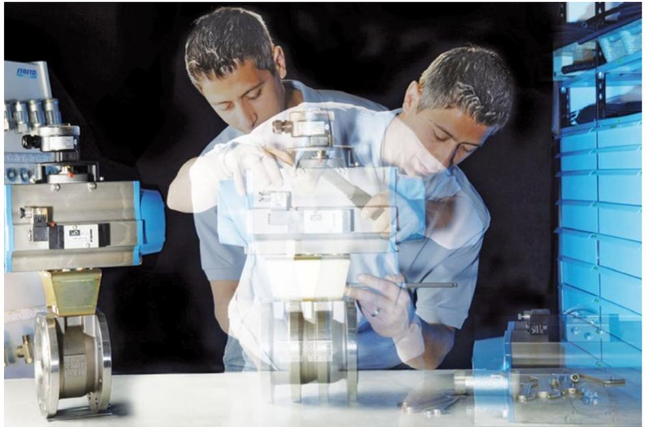
Montage eines Kugelhahns mit pneumatischem Drehantrieb
