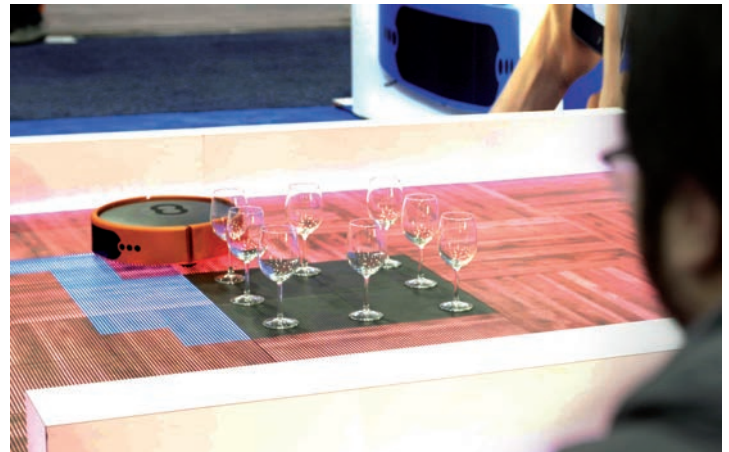
Ein Putzroboter mit dem Robart-System weiß, wo er staubsaugen soll und wo nicht. Der Roboter erkennt Wände und Türen, sieht Hindernisse, lässt sich per Smartphone kommandieren und hört jetzt sogar auf Alexa von Amazon.
