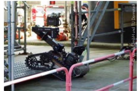
Der Roboter „Argonaut“ erklimmt im Finale eine Stufe während einer Routine-Inspektion.
