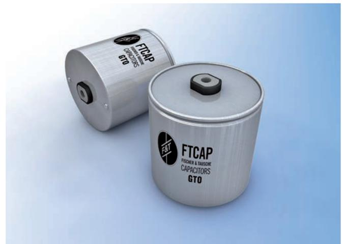
schützen und damit ihre Lebensdauer verlängern soll. Luftfeuchtigkeit führt in Kombination mit der Spannung zu einem Abbau des Metallisierungsbilags der Folien von Filmkondensatoren und erhöht so deren Verlustleistung massiv. Der eigens konstruierte Kondensator mit spezieller Aluminiumverkapselung soll im Vergleich zu herkömmlichen Ummantelungen eine deutliche Verbesserung des Feuchtigkeitsschutzes bewirken. Die Angriffsfläche der Feuchtigkeit beschränke sich deshalb außer-
