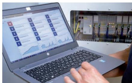
Schnelle Inbetriebnahme: Durch die webbasierte Konfiguration des IoT Gateway wurde ein Prüfstand für Hydraulikventile innerhalb eines halben Tages vernetzt.
