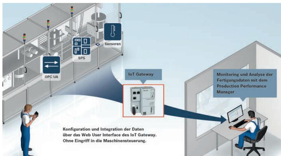
Das IoT Gateway verbindet Neu- und Bestandsmaschinen ohne Eingriff in die Automatisierungslogik mit dem Internet der Dinge (IoT).
