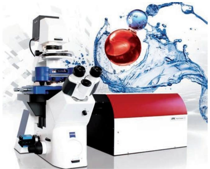
inversen Lichtmikroskop als Plattform kombiniere. Das OT-AFM Kombisystem vereinige die Fähigkeiten des Rasterkraftmikroskops, Kräfte und Eigenschaften von Oberflächen abzubilden, mit der Fähigkeit der optischen Pinzette, kleinste Kräfte in drei Dimensionen anzuwenden und zu messen. Das System erfülle laut Hersteller höchste Anforderungen an mechanische Stabilität, Flexibilität und Modularität.
