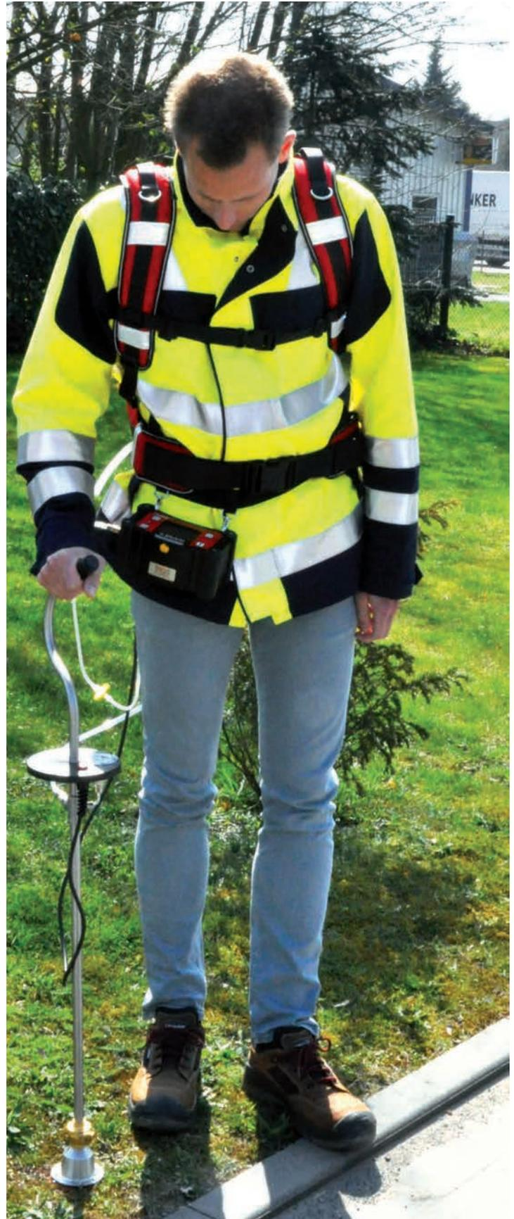
Technologie aus der Wasser- und Gasleckortung hilft beim Finden von Fehlern in Kabeln.
