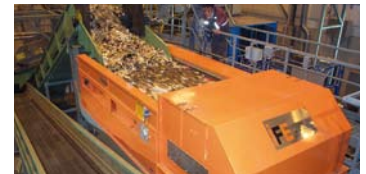
Wirbelstromscheider zur Entfernung von NE-Metallen Eddy current separator – to separate nonferrous materials
