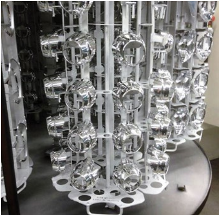
Bedampfungsvorrichtung in der Maschine und Aufnahmen für Sputter-Anlagen.
