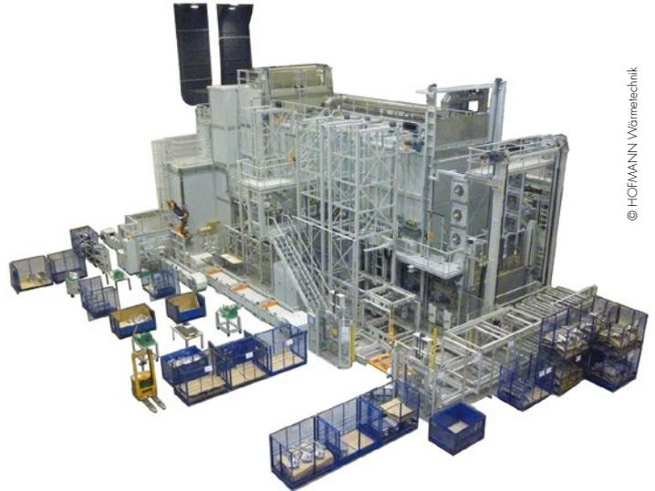
Wärmebehandlung von Federbeinstützen und Längsträgern für den Audi Q7
