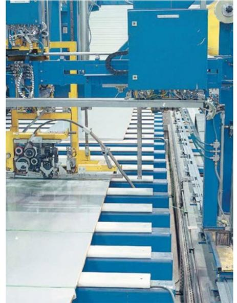
Querumreifen mit seitlich verfahrbarer Maschine und Kunststoffband
