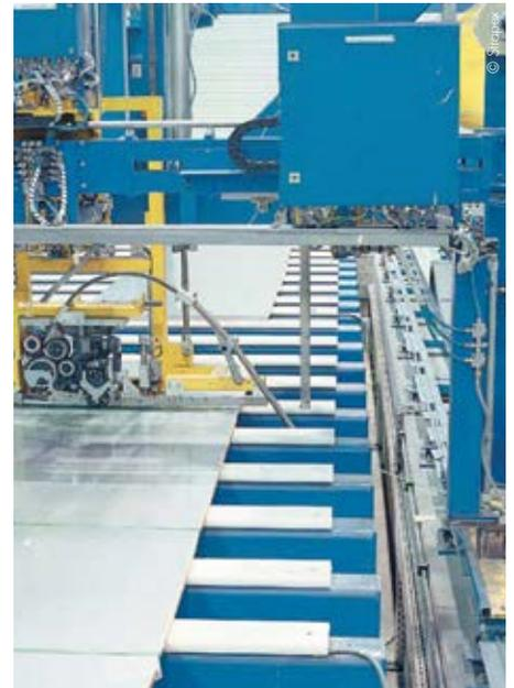
Querumreifen mit seitlich verfahrbarer Maschine und Kunststoffband
