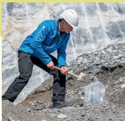
Ein TÜV AUSTRIA Experte bei einer Probenahme nach Deponieverordnung (DepVO).
