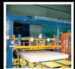
Vollautomatische Anlage zum Umreifen von Holzplatten (z. B. Plattenindustrie)
