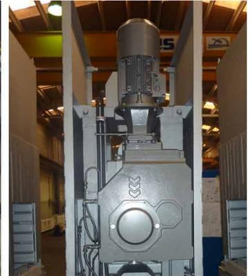
Getriebe des Typs K139 von Watt Drive treiben die Richttreiberrollen eines neuen Gussstrangs im Stahlwerk von ArcelorMittal in Belval an.
